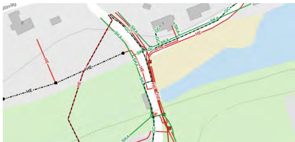
Figur 9. El-, tele- och fiberledningar i området. HE= Härryda Energi, röd = markkabel 400V, svart/röd = markkabel >10kV och svart = luftledning >10kV. SKA=Skanova (tele). GC = Global Connect (fiber). (Ledningskollen 2023).
